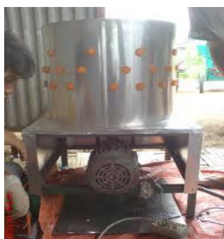
Gambar 1. Alat bubut bulu ayam kapasitas 10 ekor ayam
