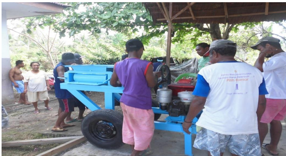
Gambar 2. Uji coba kelayakan mesin pengolah tanah lempung pada kelompok kerja
