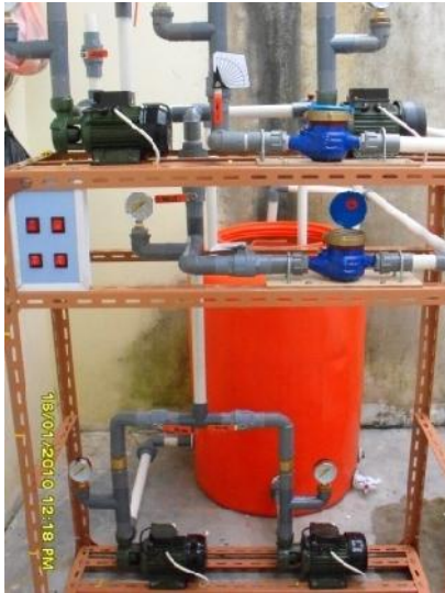
Gambar 1. Alat uji dan sketsa rangkaian pompa
