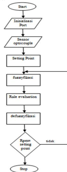
Gambar 6 Flowchart pengendalian kecepatan motor
