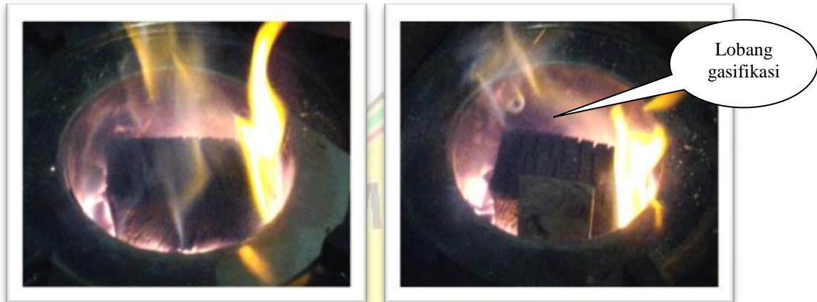
Gambar 7: Profil lobang gasifikasi pada pembakaran dengan warna api biru
