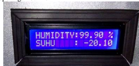
Gambar 22 Tampilan LCD Pada Freezer Portable terdapat komponen untuk komunikasi antara pengguna dengan sistem
