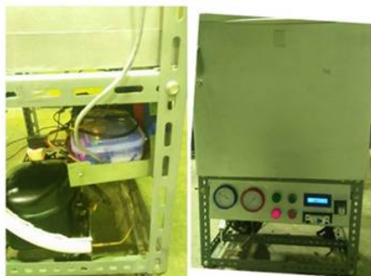
Gambar 19 Rangkaian Keseluruhan Alat Pengontrol Suhu Pada Freezer Portable
