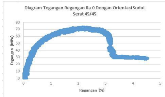
Gambar 7 Diagram Tegangan Regangan Spesimen FML dengan R_a 0.33
