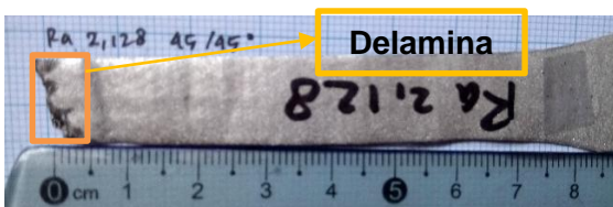
Gambar 15(e) Area delaminasi pada patahan specimen uji tarik dengan variasi R_a 2,128 \mu\text{m}
