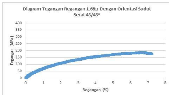
Gambar 8(a) Diagram Tegangan Regangan Spesimen FML dengan R_a 1,68 \mu\text{m}
