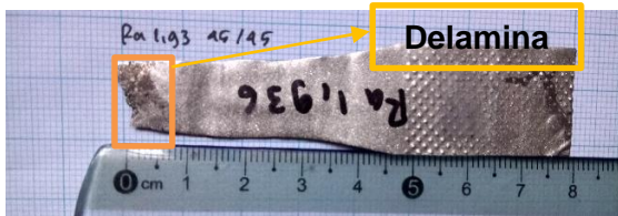
Gambar 15(d) Area delaminasi pada patahan spesimen uji tarik dengan variasi R_a 1,93 \mu\text{m}
