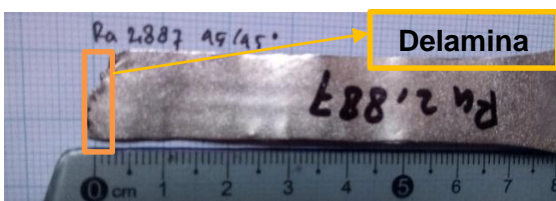
Gambar 15(f) Area delaminasi pada patahan specimen uji tarik dengan variasi R_a 2.887 \mu\text{m}
