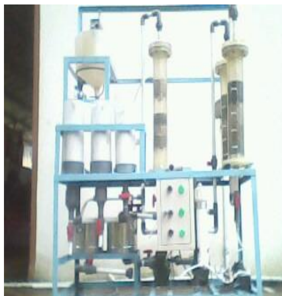
Gambar 2. Alat pengolah air payau menjadi air minum secara koagulasi, sedimentasi dan filtrasi bertingkat.
