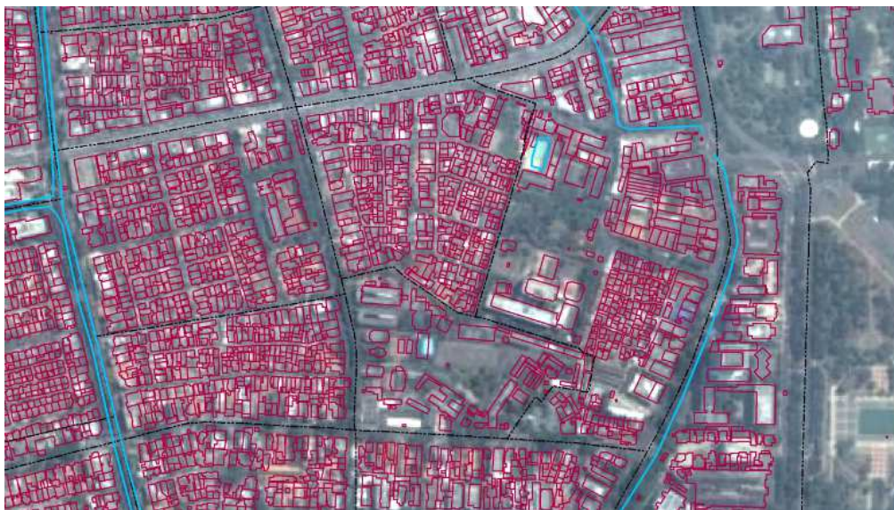
Gambar 3. Contoh model data vektor dari hasil interpretasi citra resolusi tinggi (Ikonos) daerah Jakarta Pusat.
