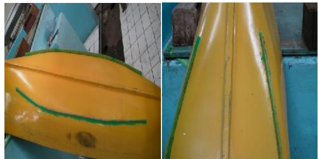
Gambar 1. Pemasangan lunas bilga pada model
