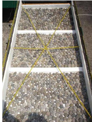
Gambar 1. Susunan penyimpanan panas pada kolektor.
