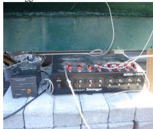
Gambar 3. Datalogger dengan 10 sensor temperatur.
