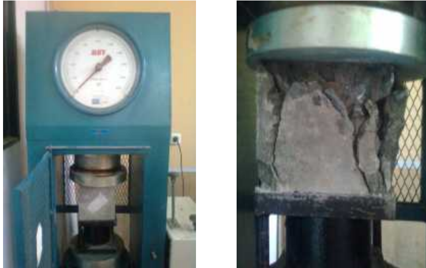
Gambar 1. Pengujian kuat tekan dengan alat compression test
