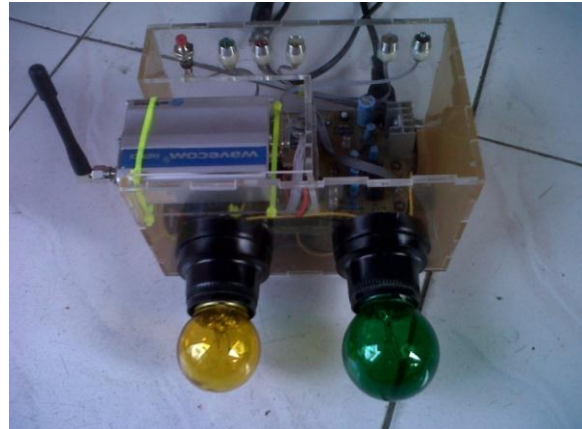
Gambar 6. Alat Pengendali PPR Menggunakan SMS Berbasis Remote control
