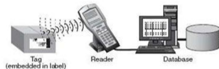
Gambar 1. Cara Kerja RFID
