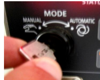
Gambar 1. Mode posisi manual pada controller
