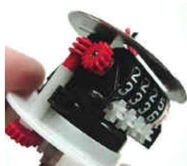
Gambar 3. Output Worm Gear Menggerakkan Poros dan Memutar Indikator
