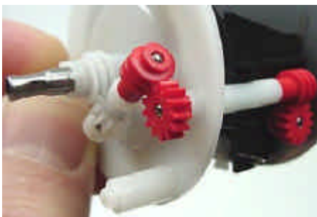
Gambar 2. Reduksi Worm Gear
