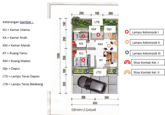
Gambar 2.8 : Denah Rumah Tinggal Berikut Perletakan Titik Lampu dan Stop Kontak
