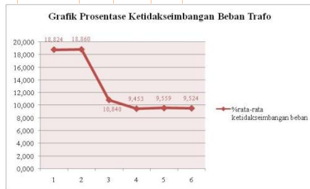
Gambar 4.14 Prosentase Ketidakseimbangan Beban 4.3. Arus Netral Trafo
