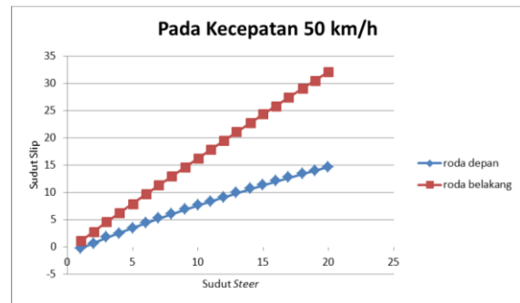
Gambar 7. Grafik sudut belok terhadap sudut slip pada kecepatan 50 km/jam
