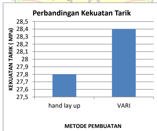
Gambar 2. Perbandingan kekuatan tarik menggunakan metode hand lay up dan VARI.
