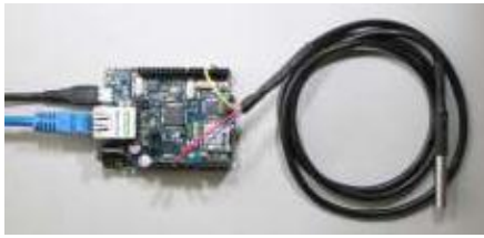
Gambar 7. Temperatur Sensor Dengan Modul Arduino
